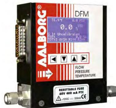
Supportano diverse funzioni, tra cui: il flusso totalizzatore, portata, temperatura, allarmi di pressione, regolazione automatica dello zero, 2 uscite relè, 0-5 Vdc / 0-10 Vdc / 4-20 mA uscite analogiche per portata, pressione e temperatura.
