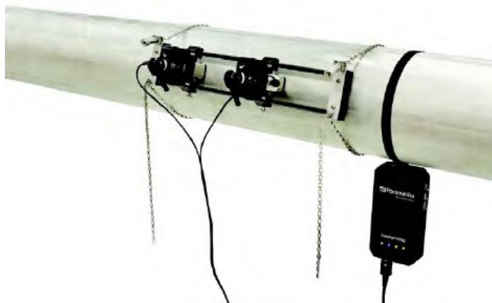
Staffa di supporto, trasduttori e trasmettitore montati su tubo
