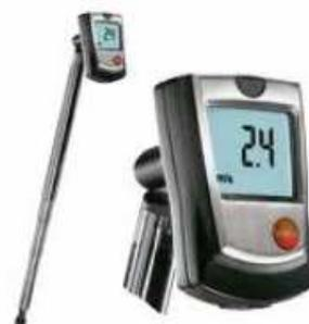
Testo 405 è un anemometro termico. Permette di effettuare misurazioni precise della temperatura, della portata e della velocità dell'aria. Testo 405 è particolarmente adatto a misurare la velocità del flusso nei condotti in quanto è dotato di prolunga telescopica (fino a 300 mm) posizionabile all'interno del condotto grazie allo speciale accessorio fornito in dotazione.
