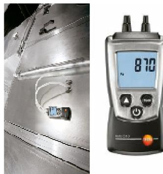
Lo strumento Testo 510 misura la pressione differenziale in un campo di misura da 0 a 100 hPa.
